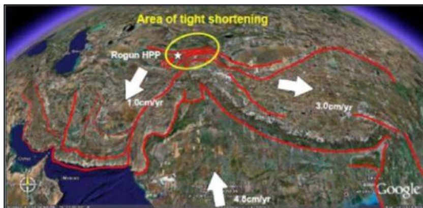
Рисунок 5: Столкновение Индии-Азии и вызванная этим деформация в пределах Евразии, Рогунская ГЭС расположена в западных отрогах Гималаев, характеризующихся интенсивным сокращением.
